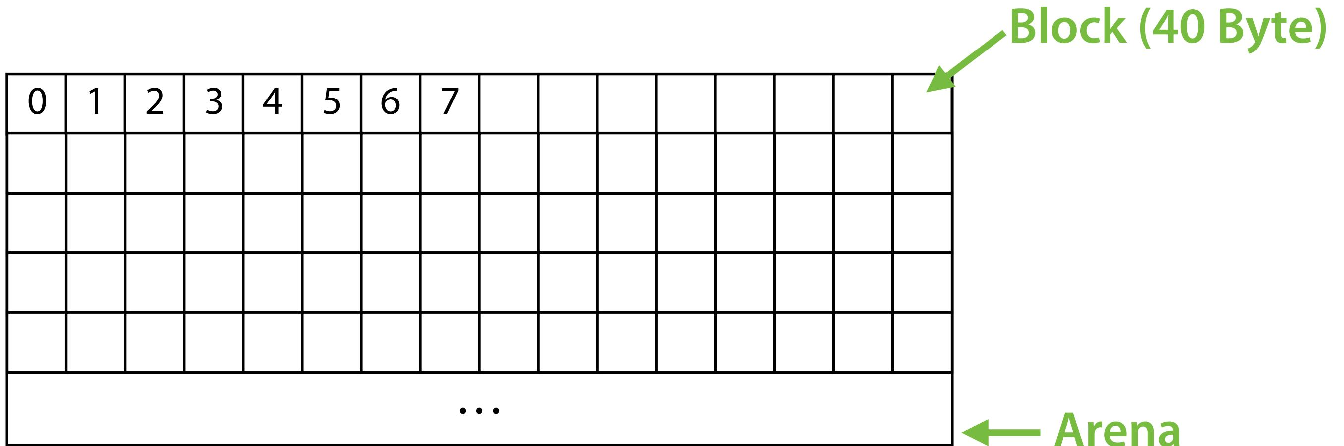
Arena wird in nummerierte 40 Byte-Blöcke unterteilt. Ein Block je Objekt.
